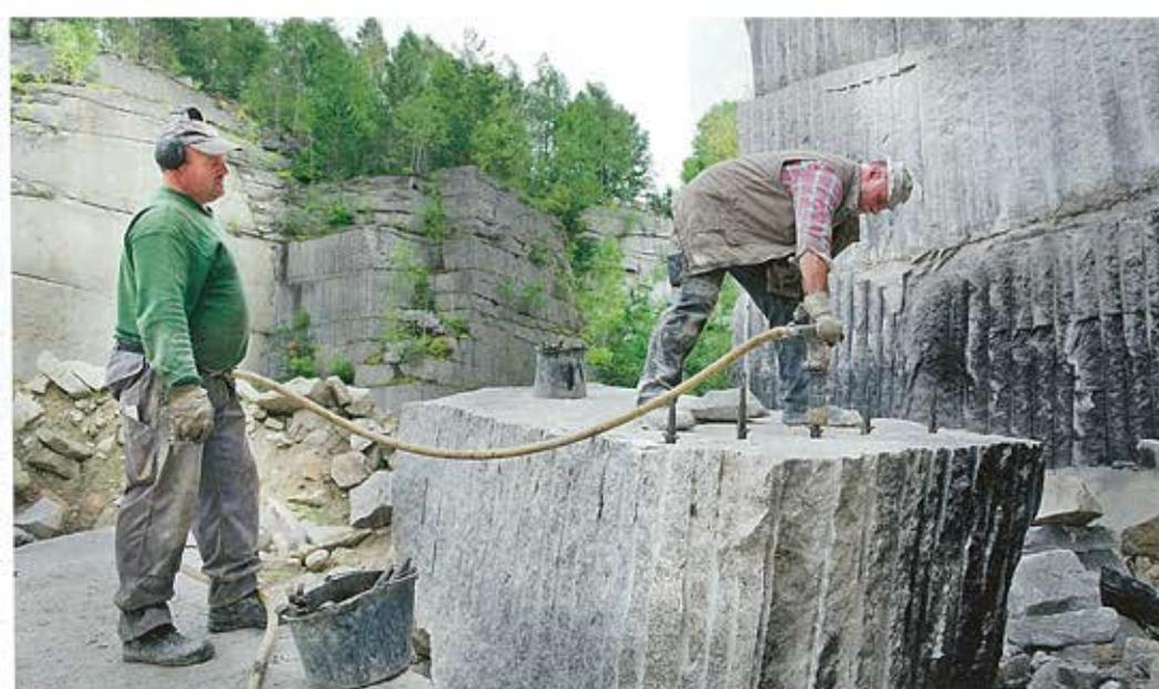
Abbau von FLOSSENBÜRGER GRANIT im Steinbruch der Firma Helgert Foto: Firma
